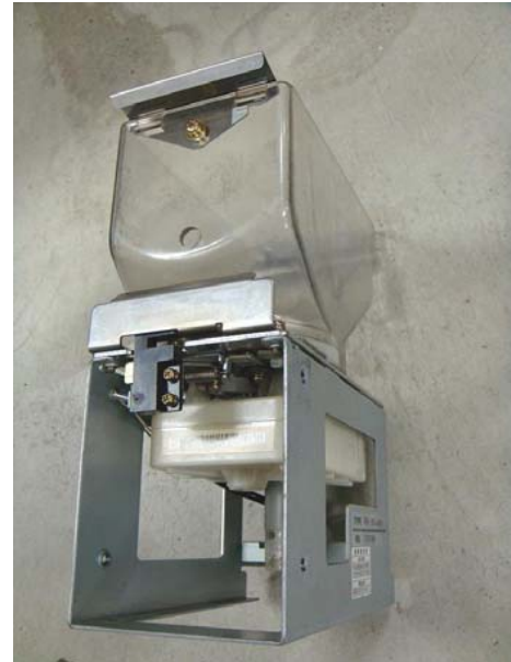
③カバー設置前 左右4本のネジで固定された正面部 品を外した状態
