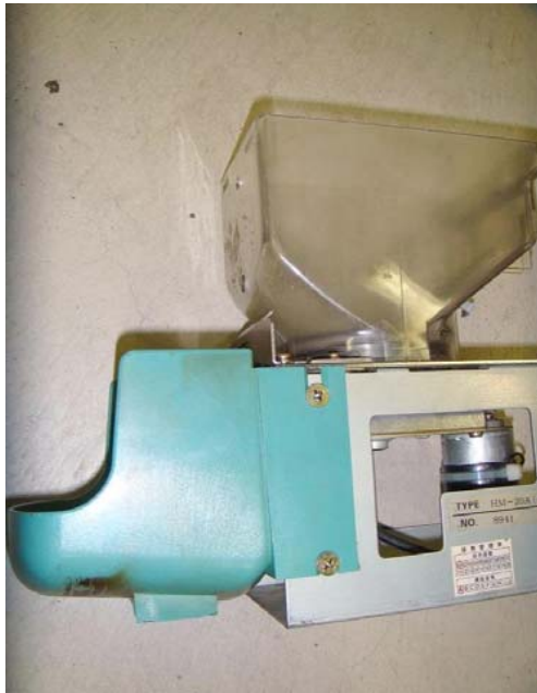
①カバー設置前 矢印のネジ4本を外す
