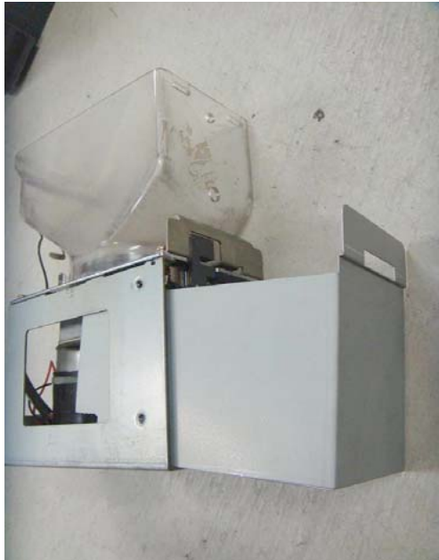
②カバーをホッパー土台内側に挿入
