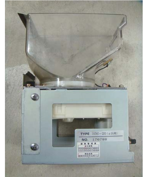
②側面 左右面のネジを外し、正面カバーを外す
