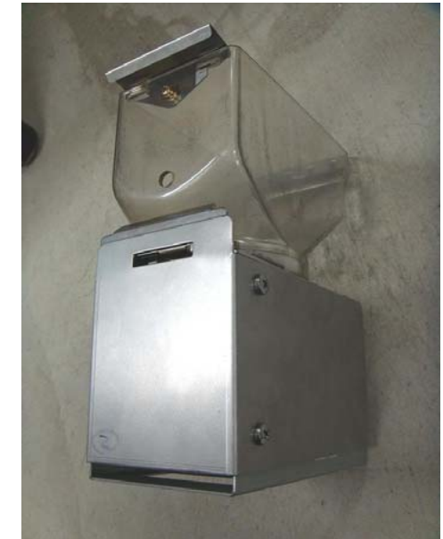
④カバー設置後 外したネジでカバーを固定
