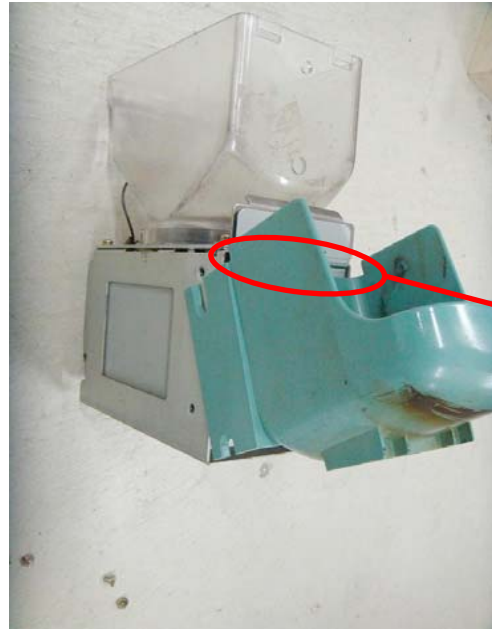
④カバー挿入後、下皿を再度固定
